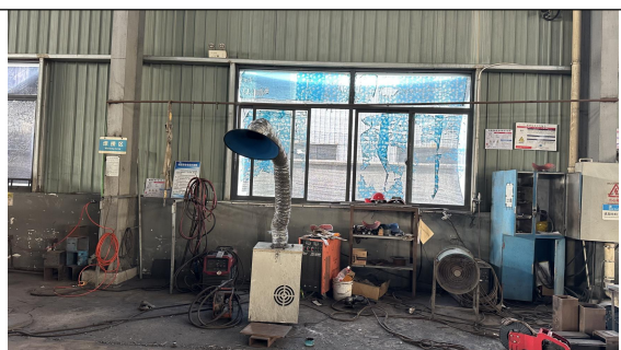
图 4-2 焊接烟尘处理装置
