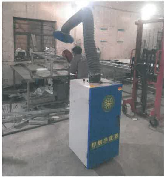
图 4-1 焊接烟尘处理装置
