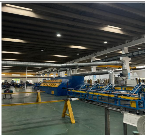
图 3-2 直缝高频焊接烟尘、刮刀粉尘、乳化液受热废气（钢管 7#生产线）收集+处理设施+排气筒（DA002）实拍图
