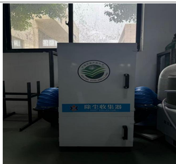
图 3-6 移动式布袋除尘器实拍图
